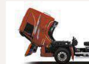
Volteo de cabina hidráulico
