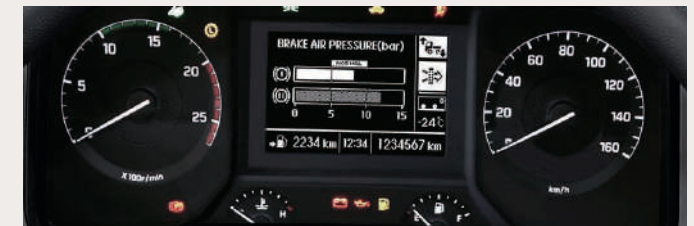
Computador a bordo con pantalla LCD TFT a color de 7"
